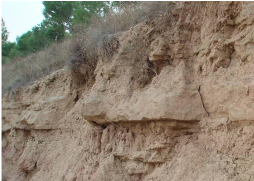
*Fotografia 3: Vista d'una diàclasi oberta per processos de moviments de massa de vessant. (Fotografia realitzada en un talús existent al dipòsit controlat veí).*
