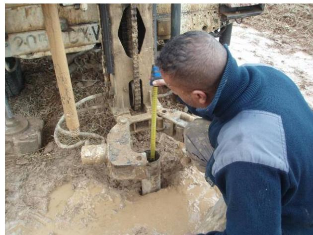
*Fotografia 9: Assaig d'infiltració AS3*
